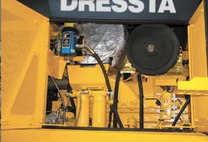
Современный двигатель CUMMINS QSK19 с электронной системой подачи топлива типа «common rail» соответствует требованиям норм по выхлопным газам Tier 3, что обеспечивает высокую производительность, минимальные эксплуатационные расходы и длительное время безотказной работы.
