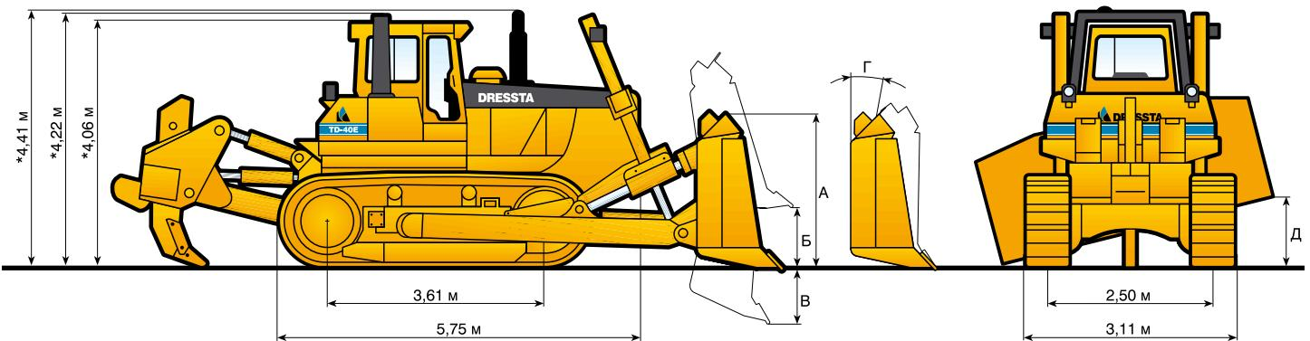
\*Размеры включают высоту грунтозацепа, которая равна 93 мм
