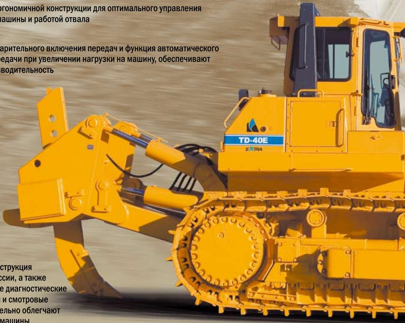
Модульная конструкция узлов трансмиссии, а также легкодоступные диагностические точки, фильтры и смотровые окошки значительно облегчают обслуживание машины
